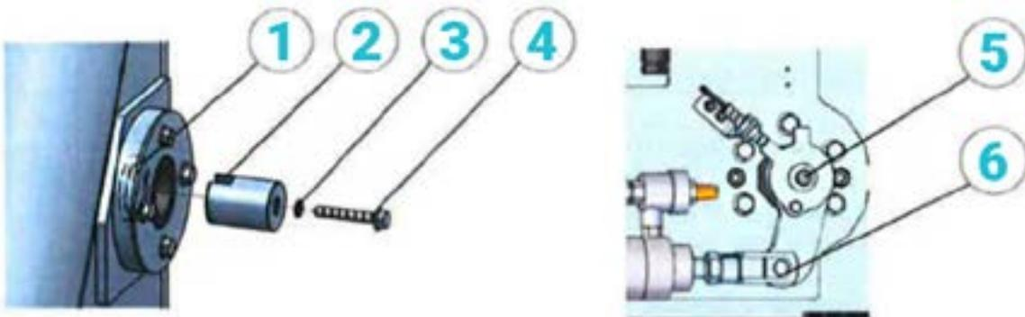
1. Démontez la vis (4), le joint torique (3) et l'arbre (2).
